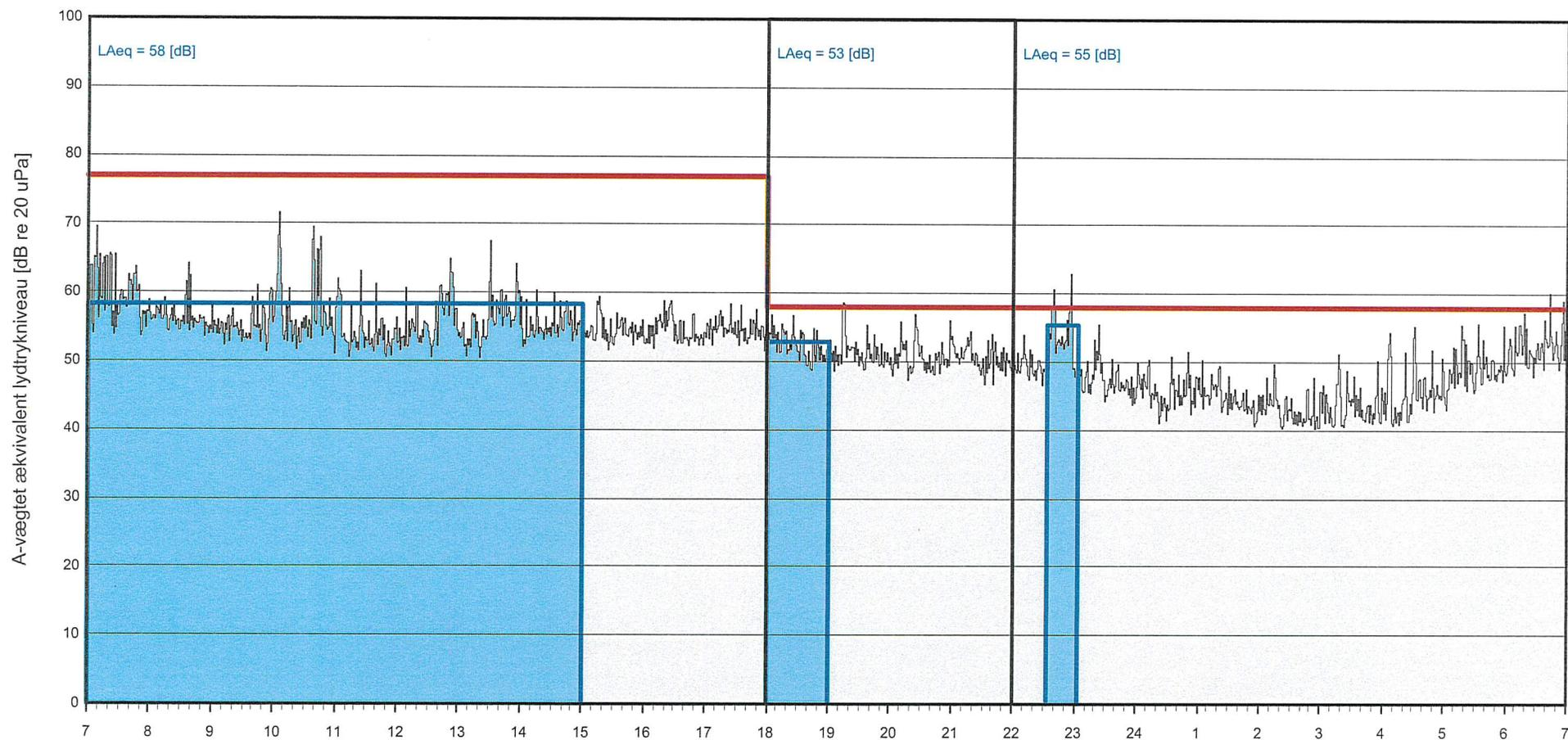
Den grå kurve viser det registrerede lydtrykkniveau LAeq pr. 1 min.
