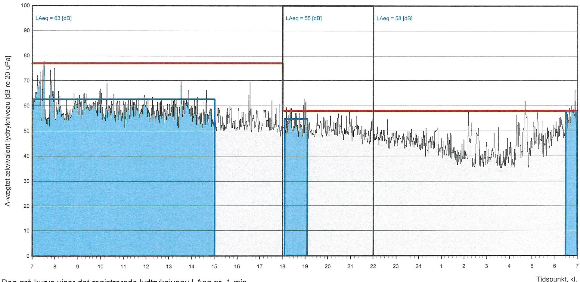
Den grå kurve viser det registrerede lydtrykniveau LAeq pr. 1 min.
