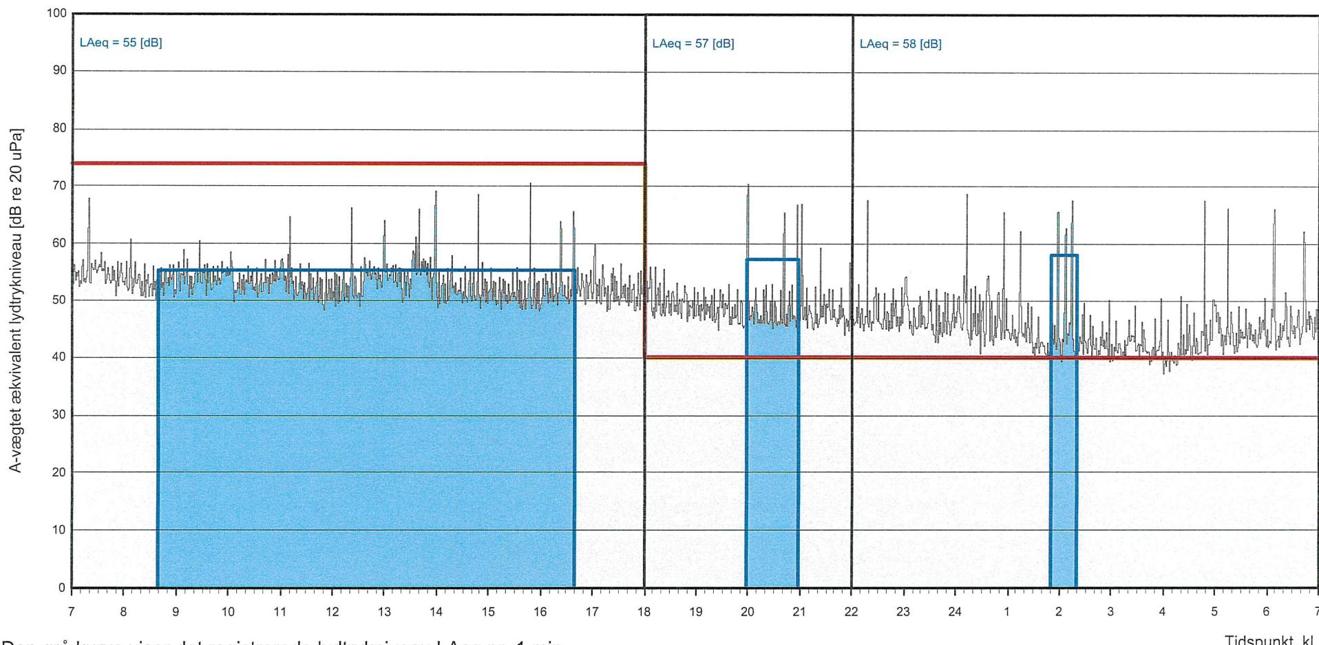
Den grå kurve viser det registrerede lydtrykniveau L<sub>Aeq</sub> pr. 1 min.
