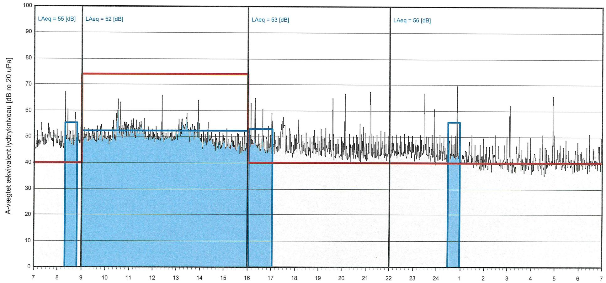
Den grå kurve viser det registrerede lydtrykniveau LAeq pr. 1 min.
